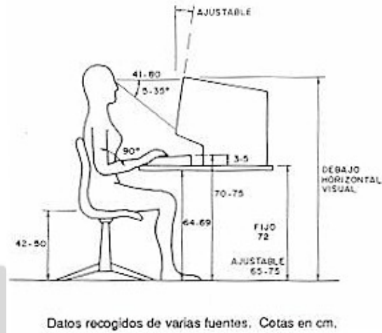
Fig. 3: Dimensiones recomendadas para puestos ante pantalla
